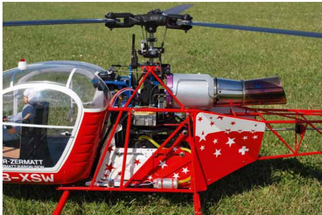
Seitenansicht der Turbine mit dem Halter für die gesamte Turbinenmechanik und dem dazwischen sitzenden Tank. Erkennbar ebenfalls die Kraftstoffpumpe (im Bild unten)
