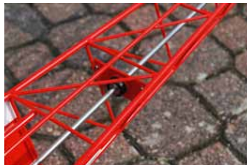
Konstruktion der Heckwellenlagerung in Verbindung mit der Edelstahlwelle. Die Schellen, mit denen die Platte am Heckausleger verschraubt wird, wurden vor der Pulverbeschichtung mit dem Rumpf hartverlötet, die Kunststoffteile lackiert
