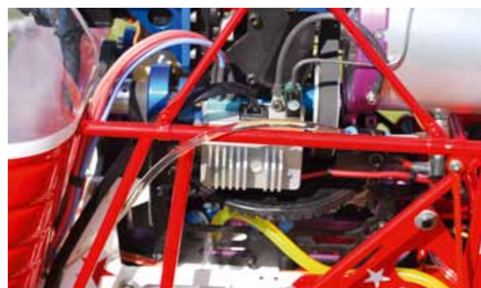
Hier sitzt der Laderegler der Turbine (silbernes Kästchen), der für den korrekten Ladestrom des Turbinenakkus verantwortlich zeichnet
