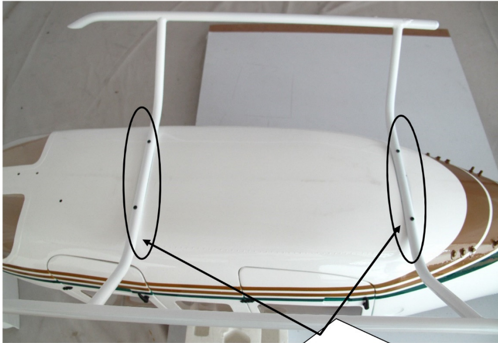
Mount landing gear 【49】 using screws 【32】 .
